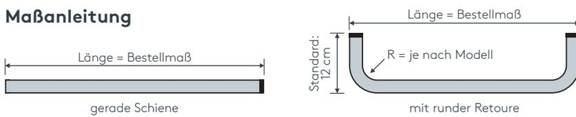
**Tip:** Bei Aluschiene von Wand zu Wand ergibt sich die Länge = Mauerlichte abzüglich 1 cm Luft.
