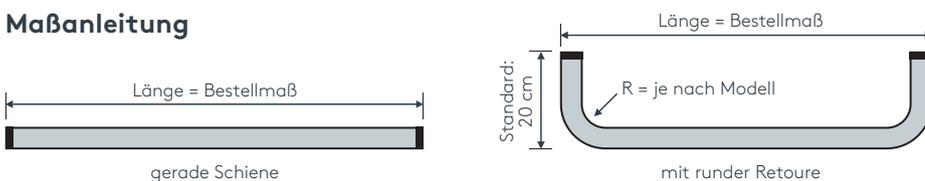
**Tip:** Bei Aluschiene von Wand zu Wand ergibt sich die Länge = Mauerlichte abzüglich 1 cm Luft.
