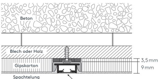
Laufschiensband (wird nach dem Gipsen im halbfeuchten Zustand entfernt)
