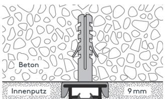
Laufschiensband (wird nach dem Gipsen im halbfeuchten Zustand entfernt)
