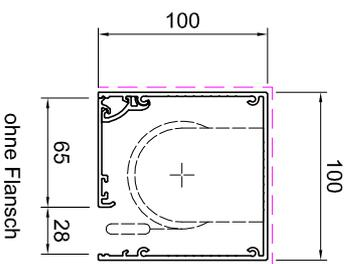
**Deckeneinbauprofil für Rollo
