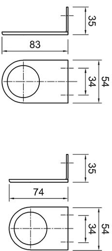
Anschraubplatte für Seilabspannung
