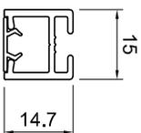
HM20120 - Tragprofil zum Einbetonieren
