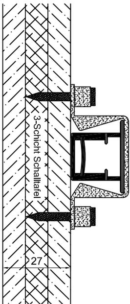
HM20122 - Betonschutzprofil wird mit Schalung entfernt
