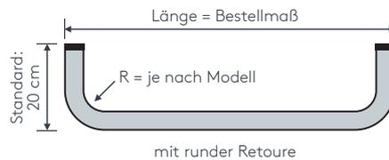
**Tip:** Bei Aluschiene von Wand zu Wand ergibt sich die Länge = Mauerlichte abzüglich 1 cm Luft.
