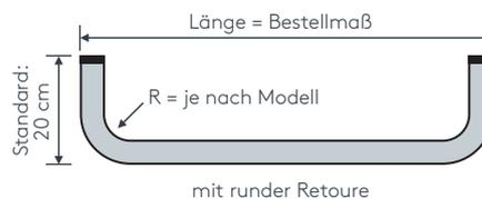
**Tipp:** Bei Aluschiene von Wand zu Wand ergibt sich die Länge = Mauerlichte abzüglich 1 cm Luft.
